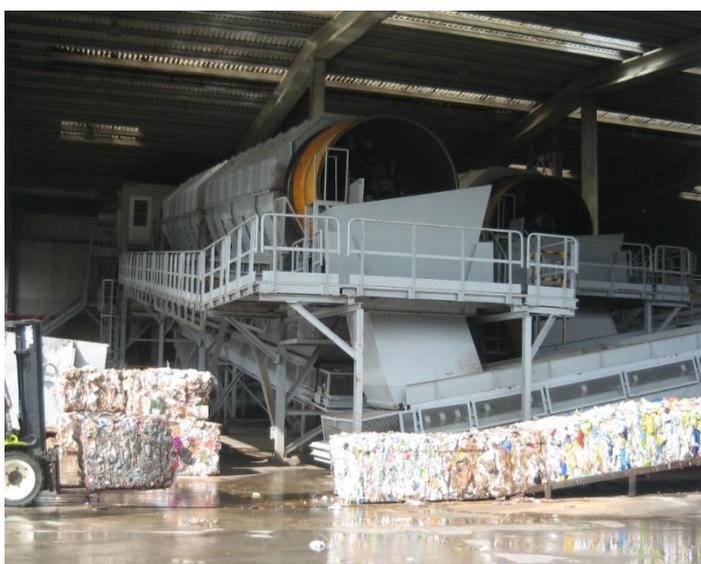
*Figura 16. Trómel de la planta integral de gestión de RSU de Cantabria.*
