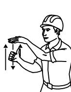
4 LEVANTAR EL AGUILÓN O PLUMA LENTAMENTE
