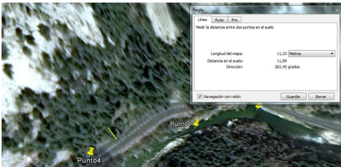
imagen 63- Medida de la anchura de la zona crítica del talud tomada mediante Google Earth
