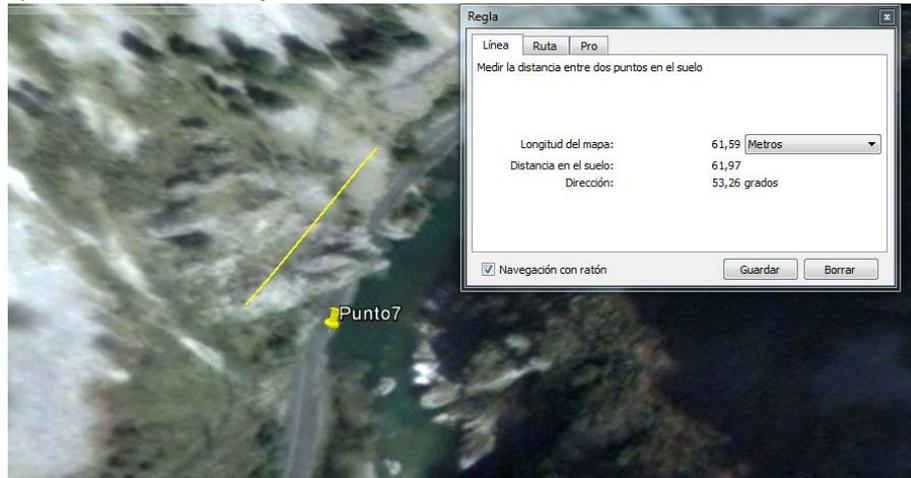
Tabla 33- Longitud sobre la que se colocará la pantalla dinámica medida mediante Google Earth
