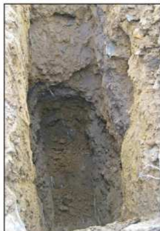
DESARROLLOS URB. DIREC. Y COORD., S.L.P. PROYECTO DE URBANIZACIÓN PSIR DE CASTRO URDIALES, AL W. DEL POLIGONO DE VALLEGON CALICATA N°: 7 PROFUNDIDAD: 6,48 m.
