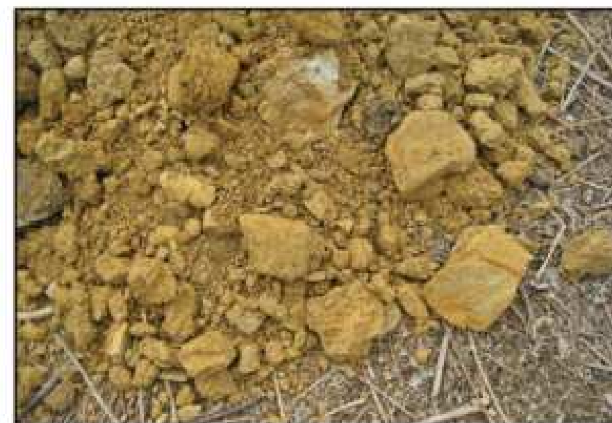
DESARROLLOS URB. DIREC. Y COORD., S.L.P. PROYECTO DE URBANIZACIÓN PSIR DE CASTRO URDIALES, AL W. DEL POLIGONO DE VALLEGON DETALLE DE LAS GRAVAS DE ARENISCA QUE APARECEN EN LA CALICATA C-7.
