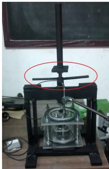
**Figura 7.4.** Mecanismo de giro con biela
