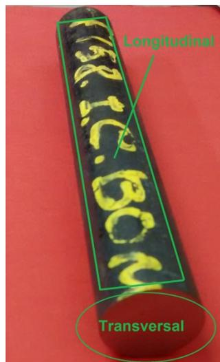
**Figura 5.2.** Orientaciones transversal y longitudinal del redondo empleado
