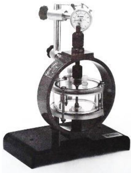
**Figura 3.1.** Dispositivo de ensayo de corrosión bajo tensión usando un anillo de prueba de carga [2]
