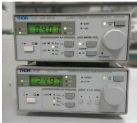
**Figura 2.4.** Fotografía del controlador de temperatura (parte inferior) junto al controlador de corriente (parte superior).
