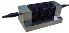
**Figura 2.3.** Fotografía de un controlador de polarización igual que el utilizado, se pueden apreciar las tres ruedas correspondientes a los  $\lambda/4$  y al  $\lambda/2$ .
