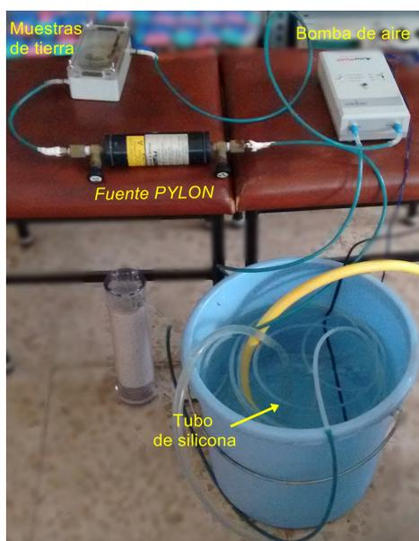
**Figura 7:** Fuente de radón en agua donde se distingue un cubo lleno de agua con tubos de silicona dentro, conectado a una bomba de aire, muestras de tierra en una caja y una fuente de radón.
