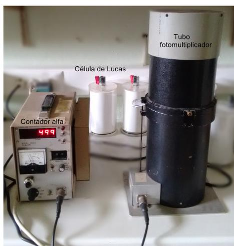
**Figura 15:** Imagen del dispositivo para la medida de las células de Lucas, donde se aprecia el tubo fotomultiplicador, el contador alfa y al fondo varias células de Lucas.
