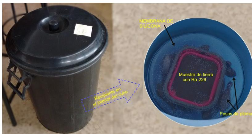
**Figura 6:** Fuente de radón en agua. A la derecha: muestra de tierra en el interior de un bol de cristal con lastres de plomo y cerrado con una membrana de silicona; a la izquierda: cubo de agua donde se sumerge la fuente.
