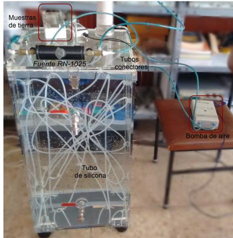
**Figura 35:** Imagen de la fuente donde se distingue un tanque lleno de agua con un tubo de silicona en su interior, y fuera un circuito de aire con una bomba, tubos conectores, muestras de tierra en una caja cerrada y una fuente de radón.
