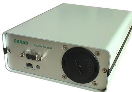
**Figura 14:** Imagen del dispositivo Radon Scout.
