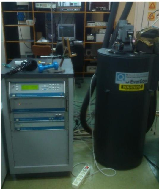
**Figura 4.2.** Fotografía del Quantum Design PPMS. A la izquierda se encuentra el software y panel de control y a la derecha el sistema de medida.
