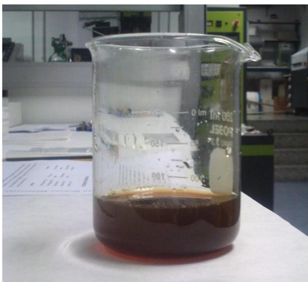
**Figura 3.2.** Precipitación que se forma tras calentar la Magnetita durante una hora y a  $100^\circ\text{C}$ . Se debe desechar la disolución restante manteniendo el precipitado en el fondo con ayuda de imanes.
