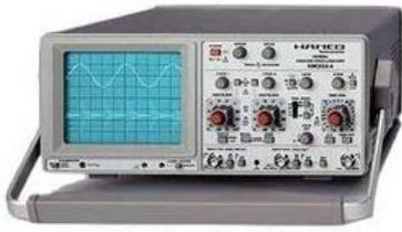
3.2.3. – Generador de funciones y osciloscopio: Estos dos equipos nos permiten modular y visualizar la señal eléctrica que suministra al circuito al que está conectado al LED.
