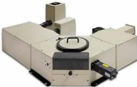
3.2.1. - Fluorímetro: dispositivo utilizado para medir los parámetros de fluorescencia de un material. Se representa la intensidad y la distribución de longitudes de onda del espectro de emisión del material, así como del espectro de excitación.
