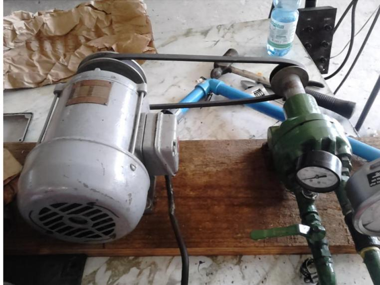
Figura 12. Bomba de aceite compuesta por un motor eléctrico y una bomba de engranajes.
