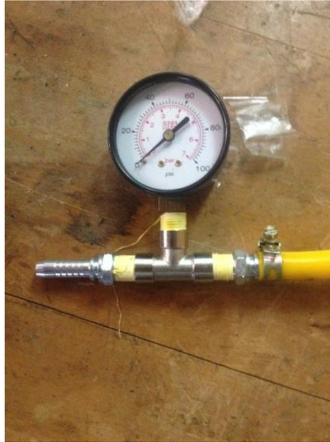
Figura 24. Medidor de presión.
