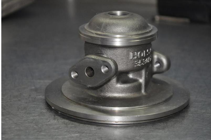
Figura 11. Cuerpo central de un Turbocompresor [10].
