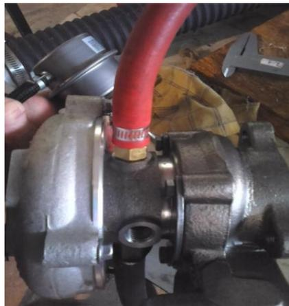
Figura 16. Manguitos de entrada y salida de aceite en el turbocompresor.
