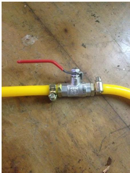
Figura 22. Válvula reguladora y de seguridad.
