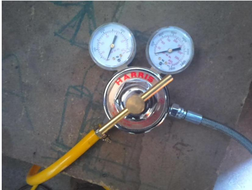
Figura 20. Sistema regulador de presión para una bombona de Propano.
