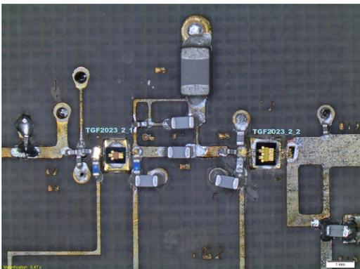
Figura 5.2.A Circuito amplificador de potencia fabricado, bajo el microscopio.
