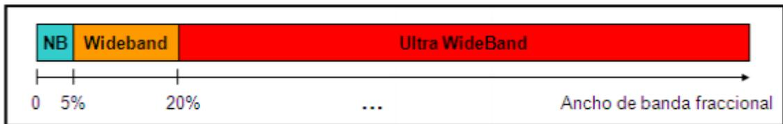
Figura 1.2 Tipos de sistemas en función del ancho de banda.
