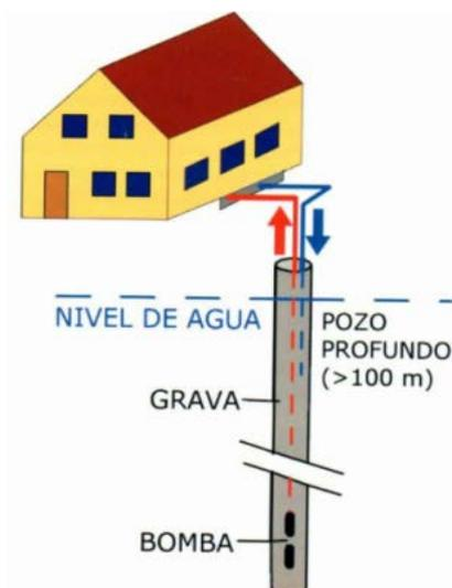
FIGURA 4: Esquema de pozo de columna estanca
