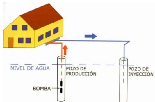
FIGURA 3: Esquema de un sistema abierto
