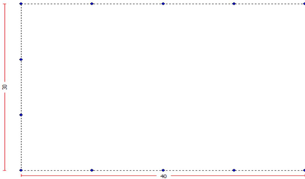
FIGURA 18: Representación de la disposición de los sensores en la primera simulación
