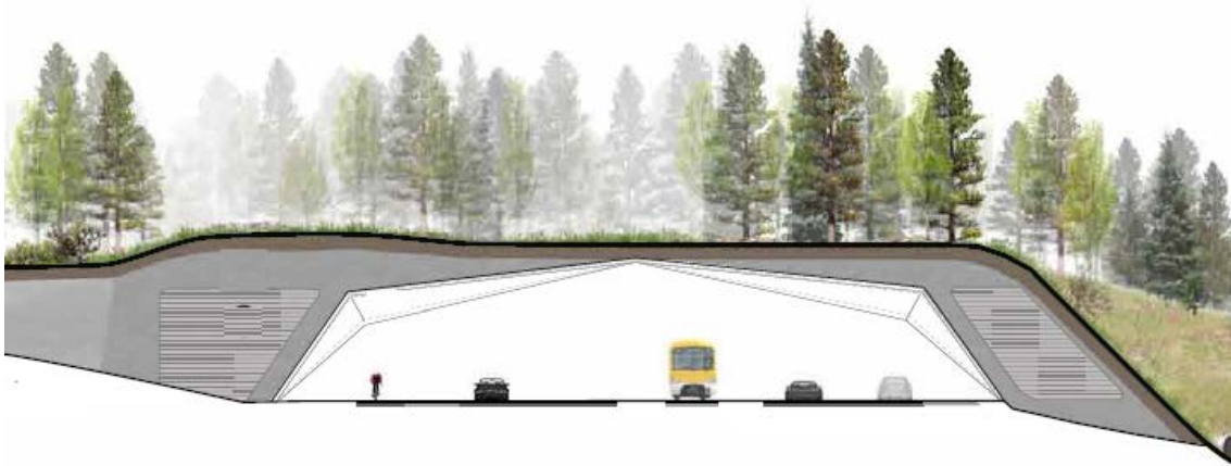
Ilustración 20. Vista general de un paso de fauna con sistema hypar. (9)
