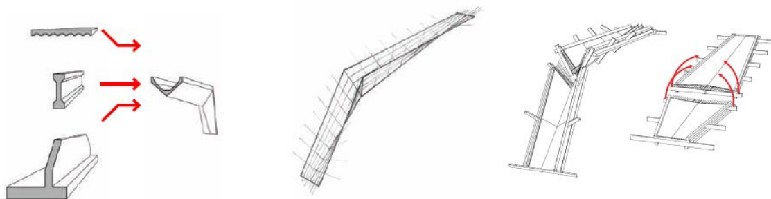
Ilustración 22. Partes de los módulos del sistema hypar. Su prefabricación es sencilla y económica ya que utiliza elementos de fácil fabricación. (9)
