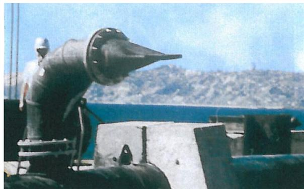
**Figura 40. Ejemplo de una válvula antirretorno colocada en la boca de un elevador saliendo del emisario.**
