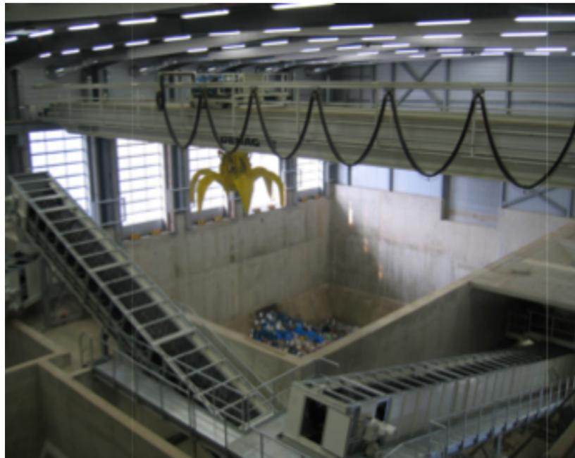
Grúa de entrada con trituradoras, cintas transportadoras, puertas y sistema de aire..
