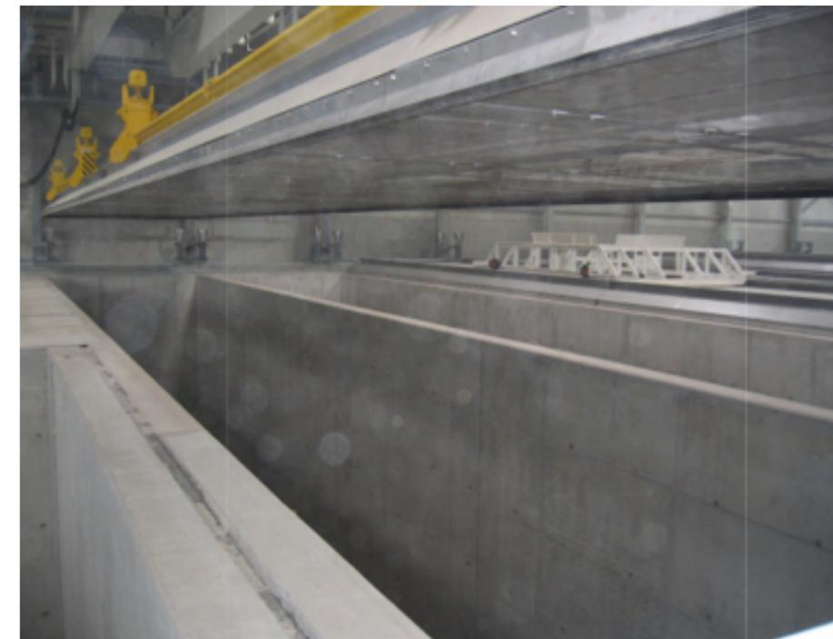
Grúa abriendo un box de biosecado y limpiando el dispositivo para las tapas.
