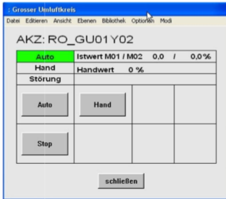
En el modo AUTO, la posición de la trampilla está controlada automáticamente por el controlador.
