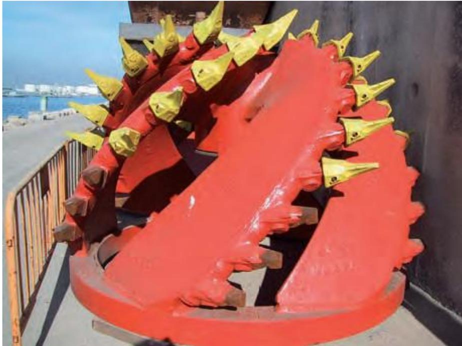
Figura 4-34: Cortador (o cutter) empleado en el dragado de roca
