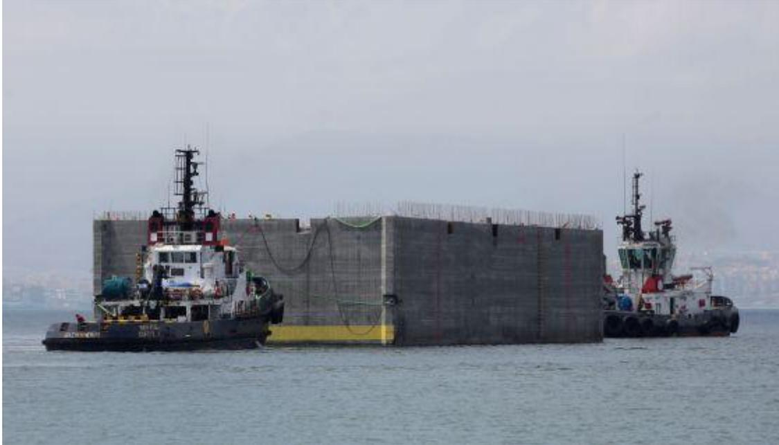
4-21: Remolcadores de FCC transportando cajones flotantes prefabricados de hormigón armado
