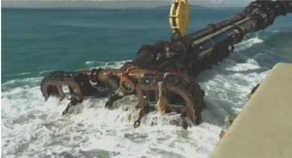
Figura 4-36: Cabezal de succión de una draga de succión en marcha
