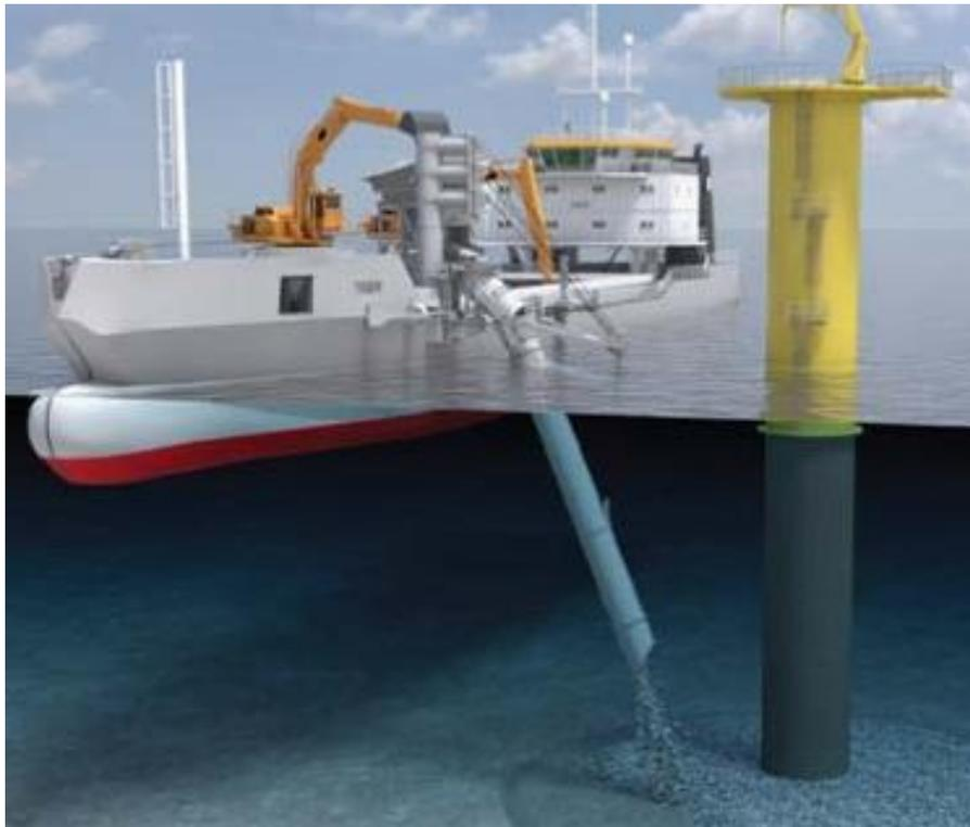
Figura 4-44: Embarcación TIGER, equipada con un sistema de posicionamiento dinámico de vertidos rocosos mediante *fall pipe*
