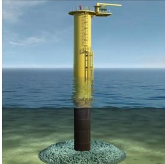
Figura 2-23: Modelado de cimentación monopilote
