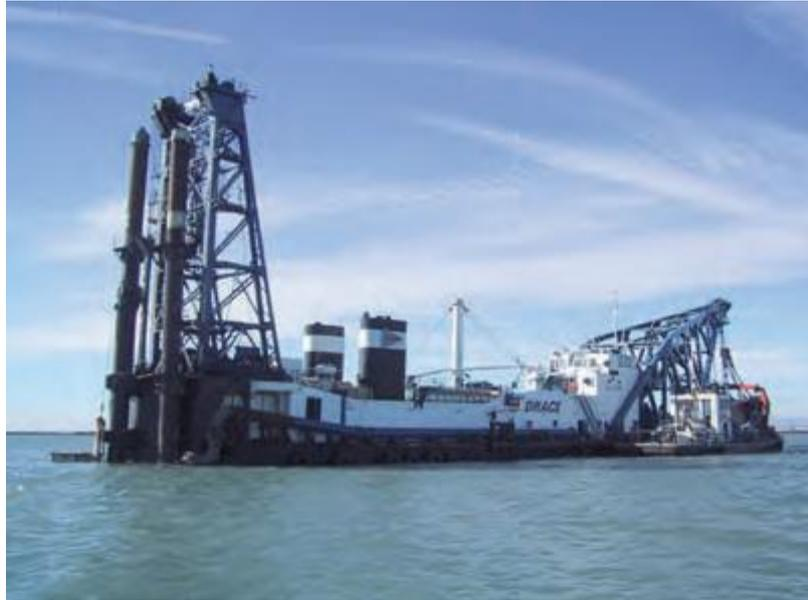
**Figura 4-31: Draga de cortador**
