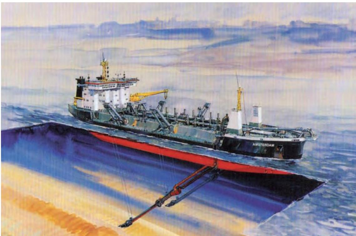
Figura 4-35: Representación de una draga de succión en marcha en funcionamiento
