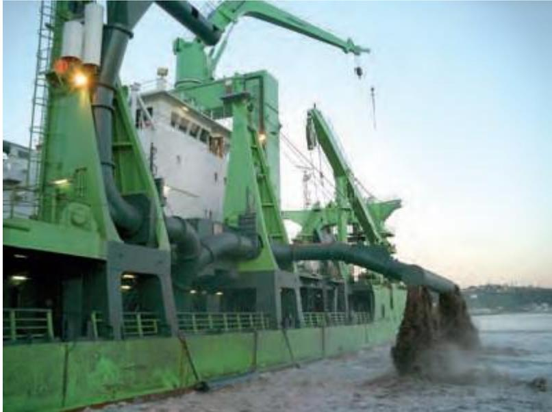
Figura 4-32: Draga de cortador vertiendo el material dragado
