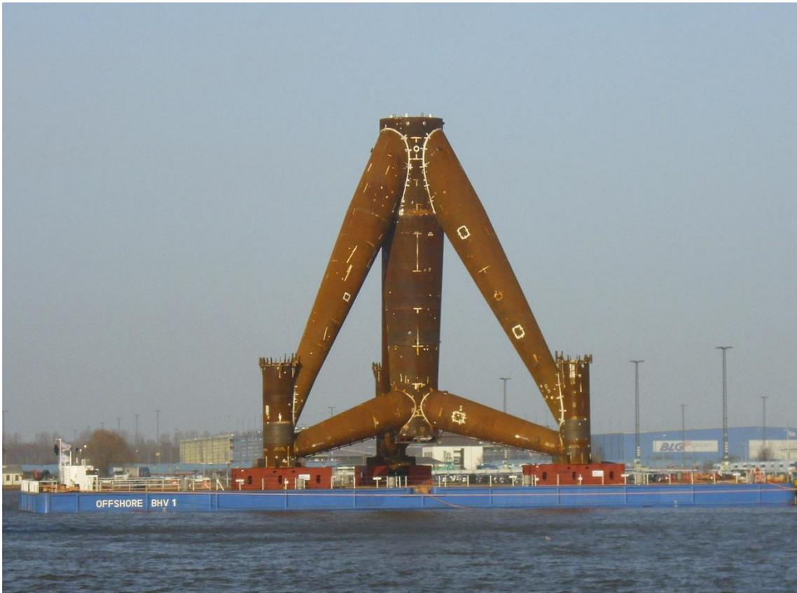
Figura 2-24: Trípode para aerogenerador offshore en el puerto de Bremerhaven, Alemania
