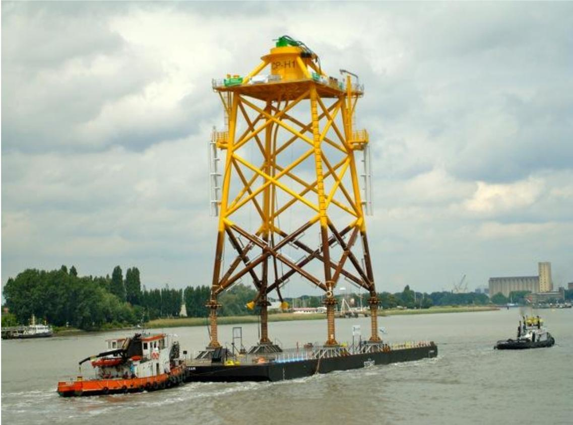
Figura 2-26: Transporte de estructura jacket al parque eólico de *Thorntonbank*, en Bélgica
