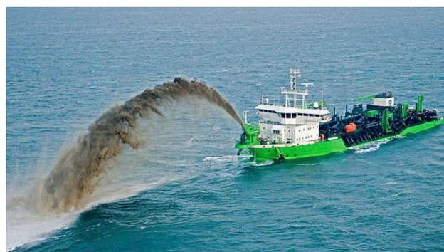
5.1.3-1: Draga de succión en marcha realizando vertido de material mediante cañón de impulsión
