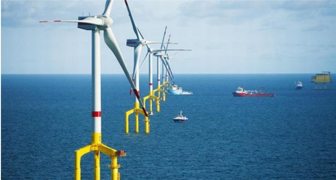
Figura 2-25: Parque eólico de BARD, Dinamarca, donde se emplean cimentación de tri-pilote
