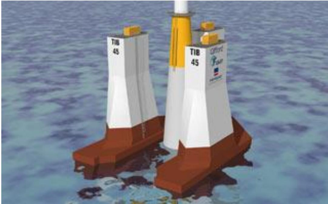
**2-49: Embarcación TIB transportando aerogenerador offshore**
