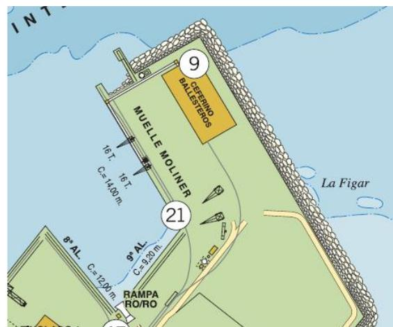
3-5: Detalle en planta del muelle Moliner
