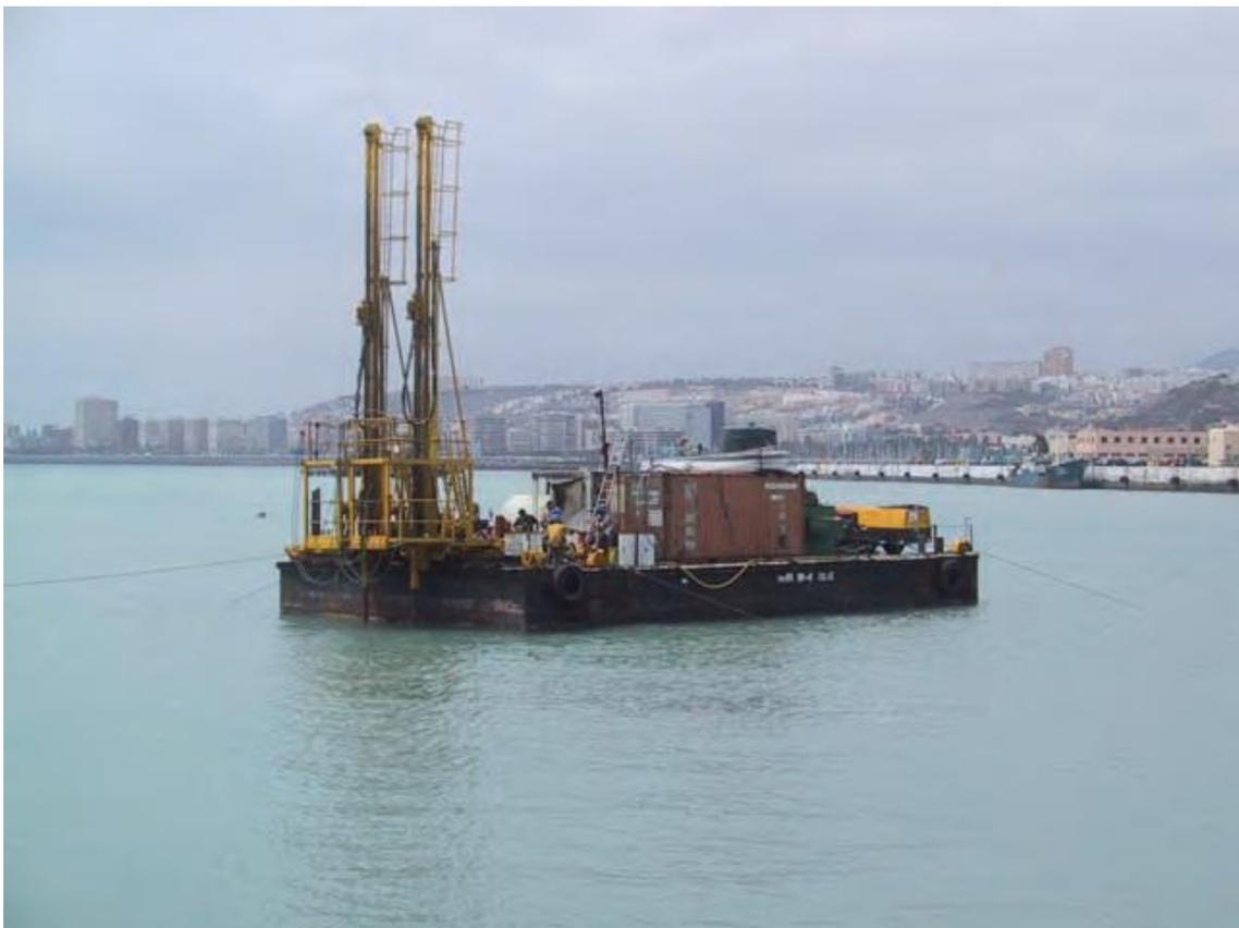
**Figura 4-38: Pontona flotante para perforación**
