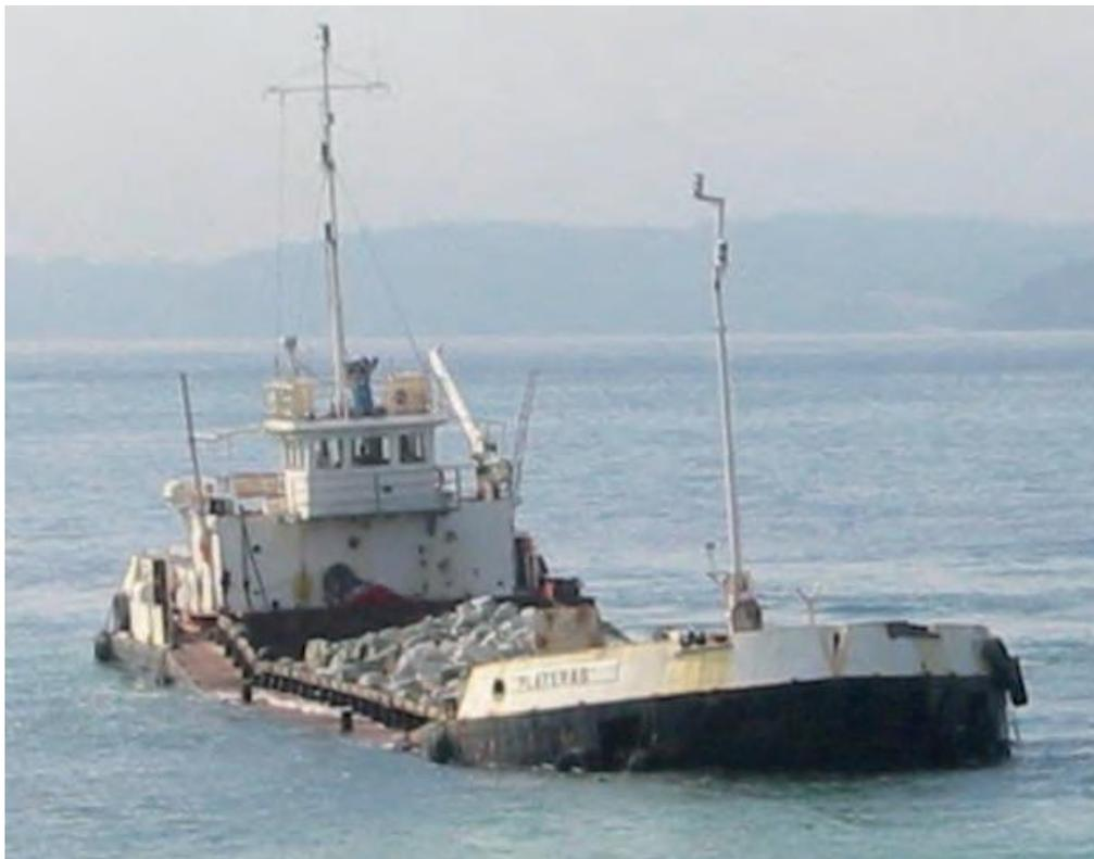
Figura 4-41: Gánguil transportando material para una banquetta
