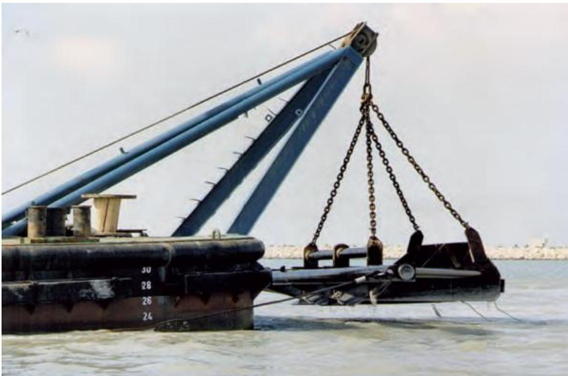
Figura 4-47: Enrasador de vigas metálicas
