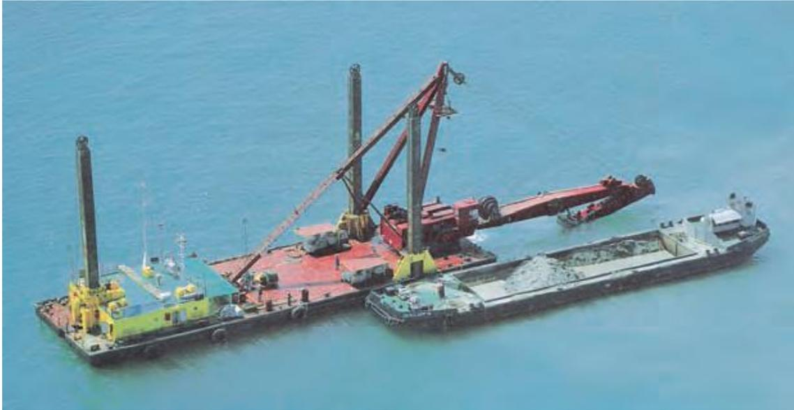
**Figura 4-29: Draga retroexcavadora en funcionamiento con gánguil abarloado**
