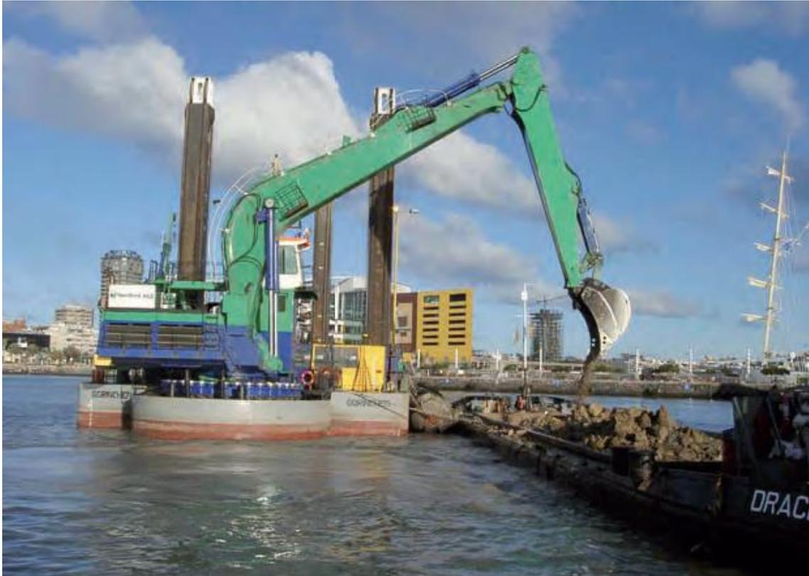
**Figura 4-28: Ejemplo de draga de pala retroexcavadora en funcionamiento**
