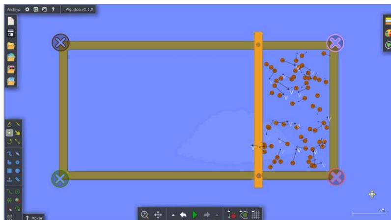
Se diseña una simulación como la que se está viendo en la figura anterior. Se debe realizar una caja en cuyo interior se dibujen pequeñas bolas caracterizadas cada una de ellas con una dirección de la velocidad diferente. Asimismo, se tiene que mover el émbolo para que el volumen disminuya y se aprecien los choques que se producen.
