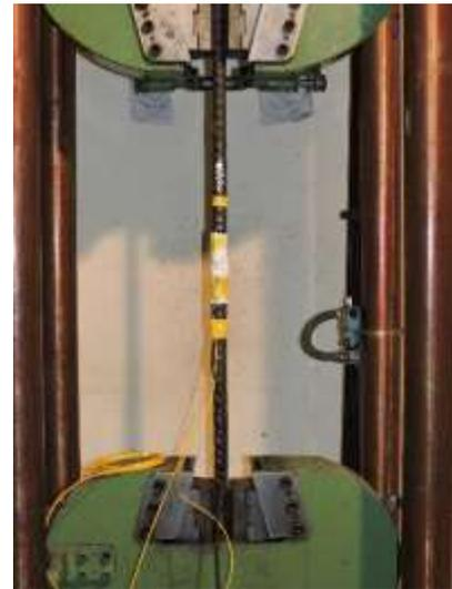
*Figura 3- 15 Montaje de la Barra Calibrada en el Pórtico de Tracción*
