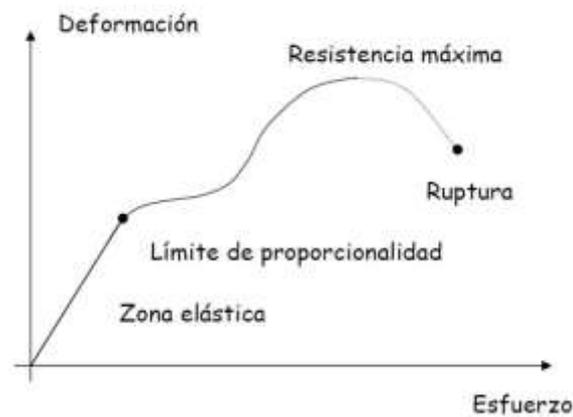
Figura 2-1 Gráfica Tensión-Deformación
