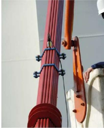
*Figura 1- 1 A Acelerómetro en tirante. Cuerda vibrante.*
