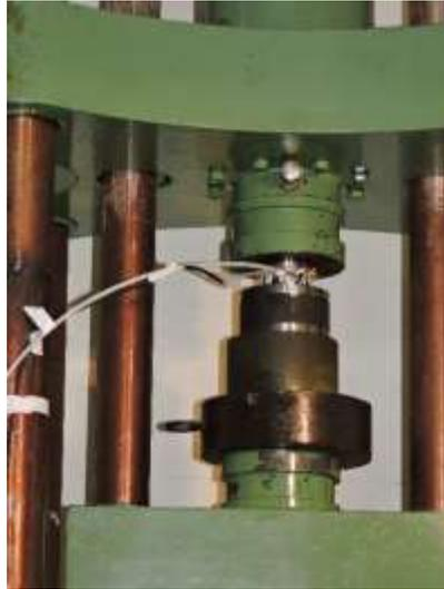
*Figura 3- 11 Célula de Carga Instalada en el Pórtico de Carga*
