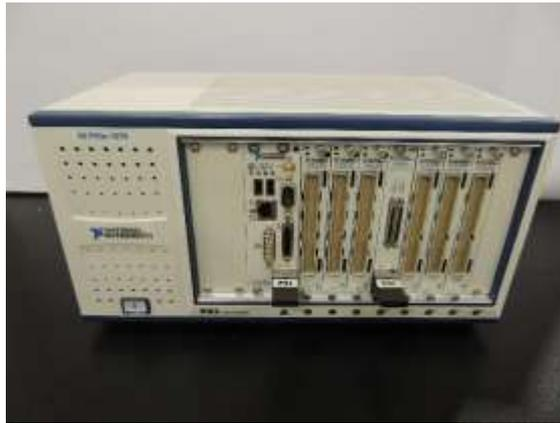
Figura 0- 6 Equipo de Adquisición de Datos de NI
