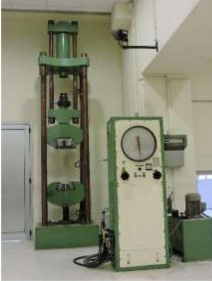
Figura 3- 6 Pórtico de ensayo con Grupo Hidráulico
