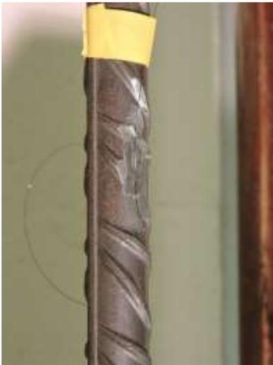
*Figura 3- 16 Instalación de los Gratings Ópticos a la Barra Calibrada*
