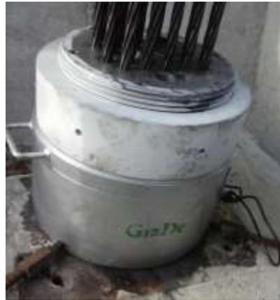
*Figura 0- 2 Célula de Carga en uno de los tirantes del Viaducto del Tajo*
