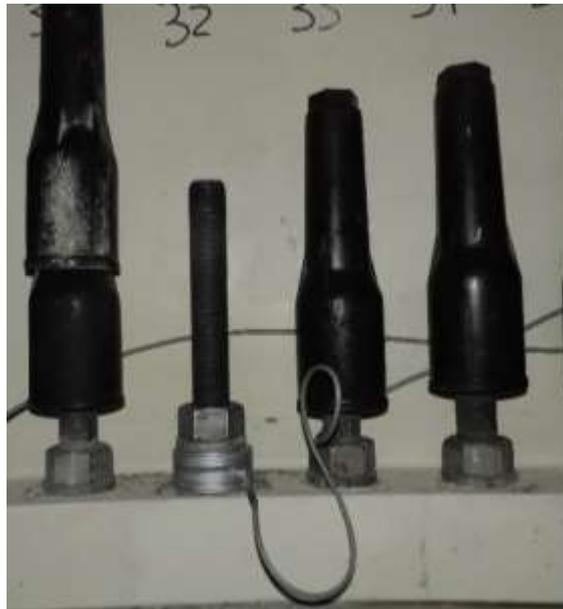
*Figura 0. 7 Célula de Carga Instalada en un Perno de una Torre Eólica*
