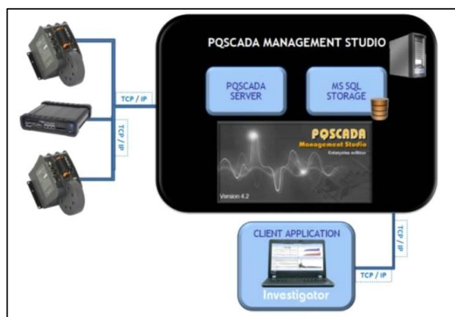
Fig.3.9 Esquema estructura comunicación en el sistema [Fuente:user manual.pdf]
