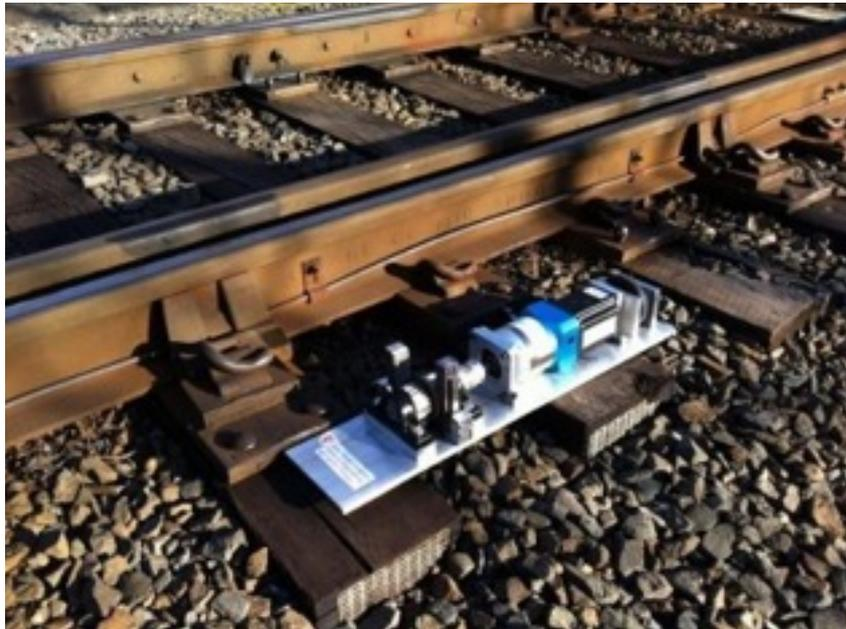
*Figura 8: Sistema che prende l'energia delle vibrazioni dei treni*
