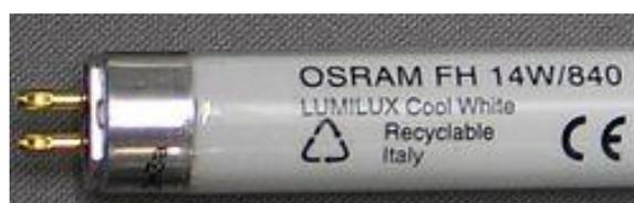
*Ilustración 5 Tubo fluorescente con una marca 840, que indica un IRC de 80 a 89 y una temperatura de color de 4000 K (Blanco natural)*
