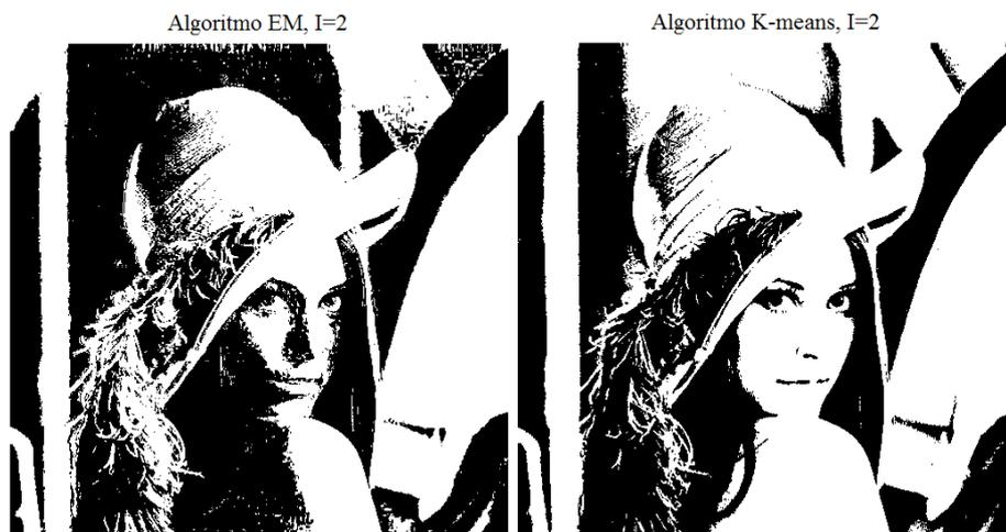
Figura 4.46: Segmentación de imágenes, análisis comparativo clústering, escala de grises  $I=2$
