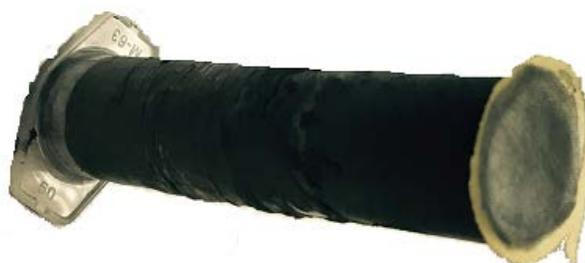
*Figura 20. Electrodo de pasta de carbón.*
