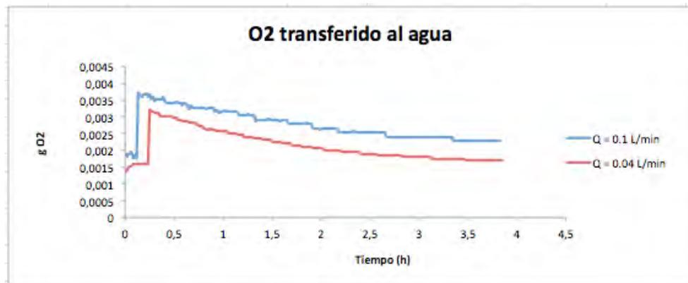
**Figura 2.25.** Comparación de los gramos de oxígeno transferidos del aire que pasa a través de la membrana al seno del líquido para los diferentes caudales.
