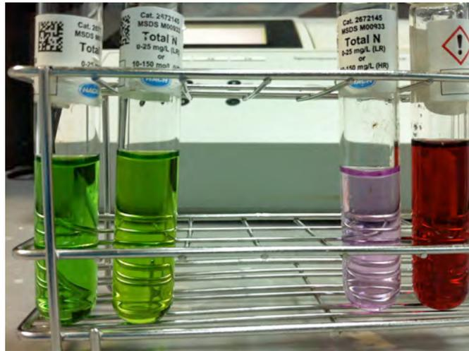
**Figura 2.39.** Ensayos con métodos fotométricos de amonio, nitritos y nitratos.
