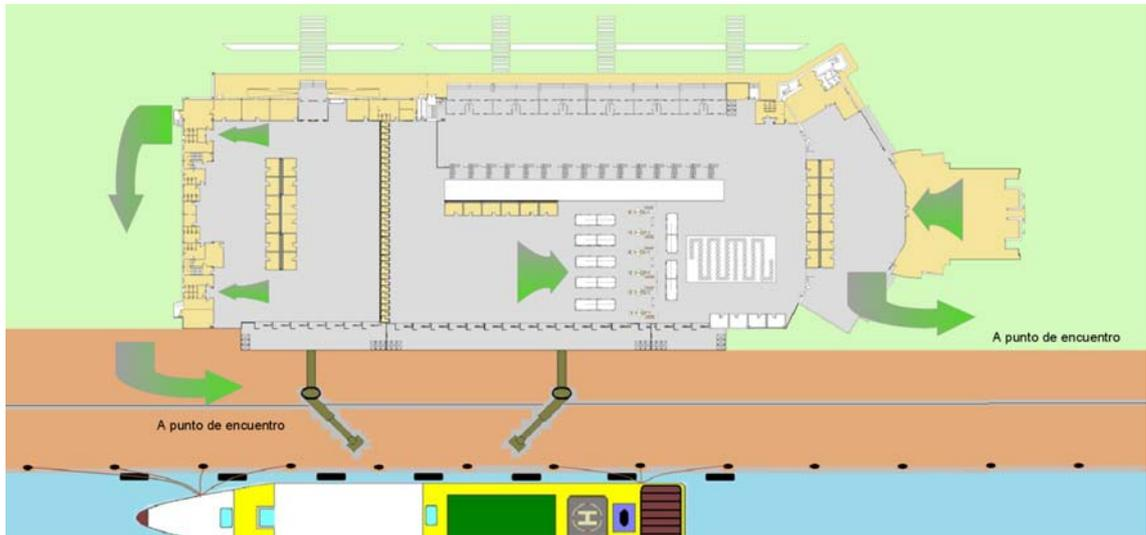
Figura 56: Planta de salidas; recorrido de evacuación a zona restringida
