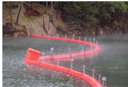
*Figura 7: Barreras flotantes Worthington SCB-32; detalle de la unión entre los flotadores y las balizas*
