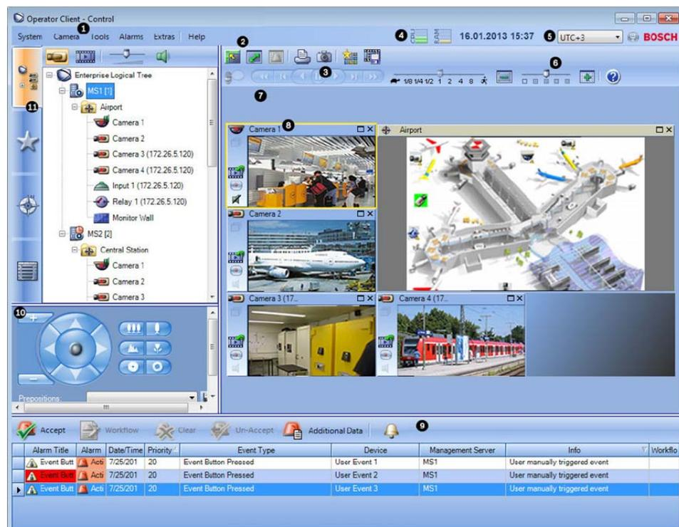
Figura 14: Presentación de software Bosch Video Management System v.5.0, integrable, para gestión de video y alarmas
