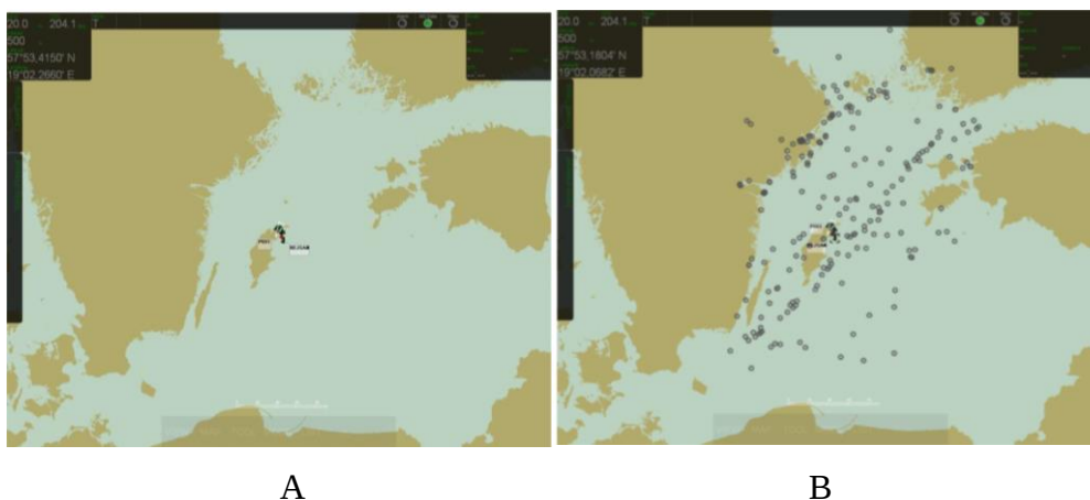
Figura 39: Comparativa entre alcance de ecos AIS recogidos desde un buque A y desde una aeronave B. Fuente: Saab Secure AIS AIRBORNE Systems, System Overview. [22]
