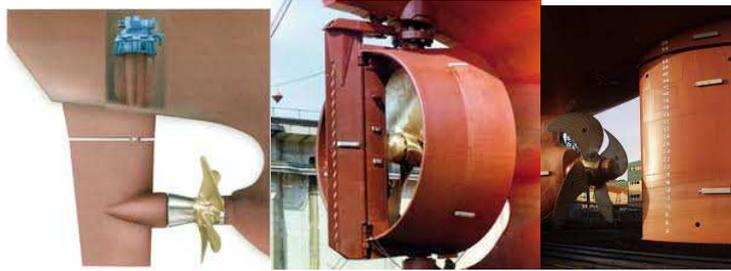
Con una configuración de doble hélice, los propulsores pueden operar de forma independiente, ofreciendo la posibilidad de controlar un propulsor avante y otro atrás, y del mismo modo operar sobre los timones de forma independiente, proporcionando así una mayor maniobrabilidad al buque. Los timones más utilizados son los timones semicompensados articulados tipo Becker, por su mayor capacidad de evolutiva a la hora de maniobrar.
