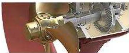
**Propulsores “swing-up & combi”:** Este es un acimutal de hélice en tobera cuya característica principal es la de ser retraible. La plataforma junto con el propulsor pivota, entrando en un alojamiento del casco. De esta manera se evita el rozamiento de este apéndice,
