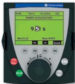
**Figura 3.3** Terminal gráfico extraíble del variador Altivar 71.
