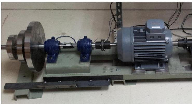
**Figura 3.24** Fotografía del motor asíncrono con los volantes de inercia acoplados a su eje.
