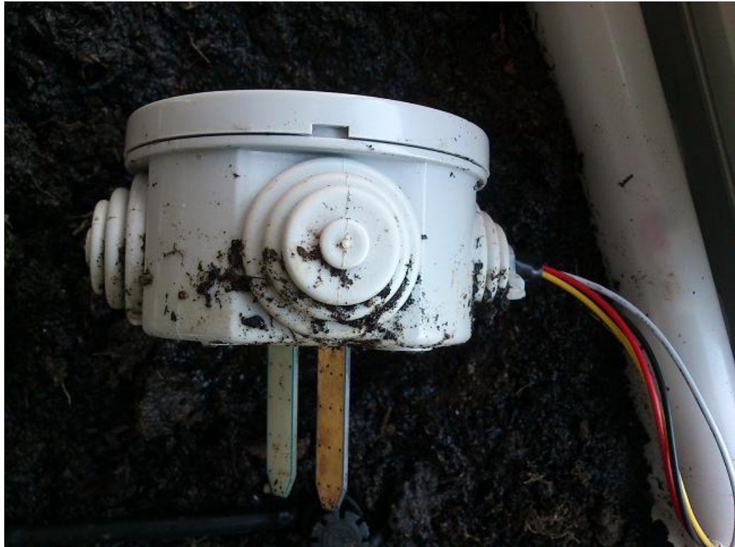
Figura 97 Caja estanca redonda con Sensor humedad suelo
