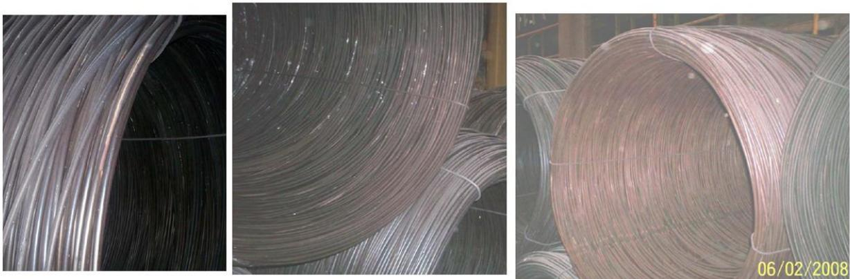
**Figura 19. Ejemplos de defectos en la homogeneidad de color.**
