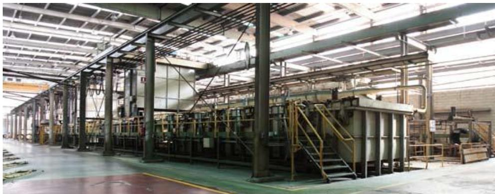
Figura 16. Instalación del decape químico de Trefilerías Quijano,S.A.
