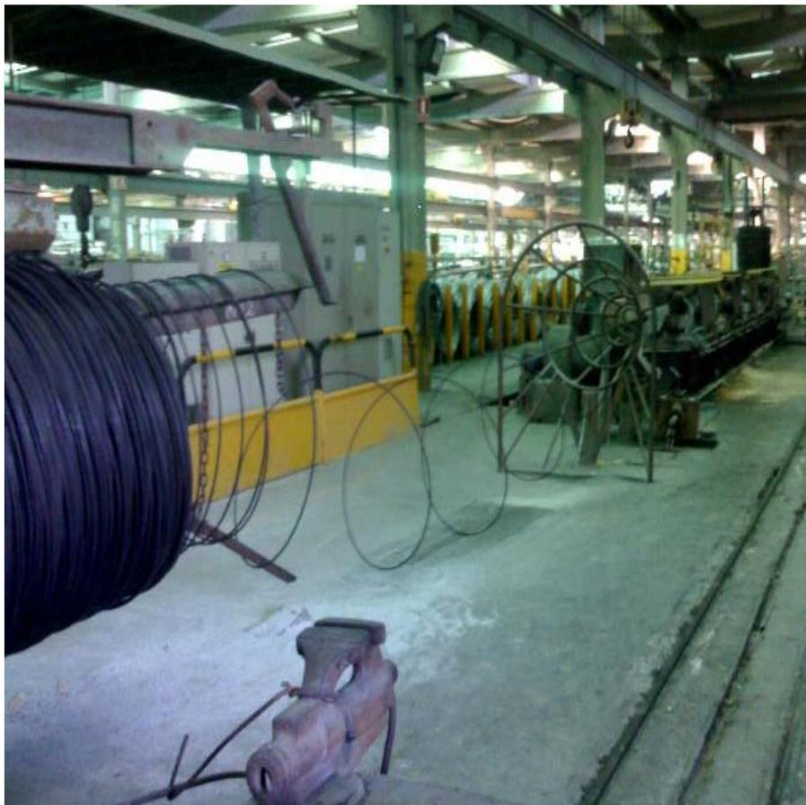
Figura 14. Máquina de trefilar en funcionamiento
