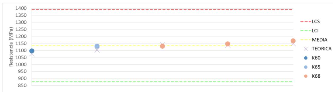
**Figura 43.** Resistencias a tracción de K53- K70 y representación de los límites de control reales y teóricos
