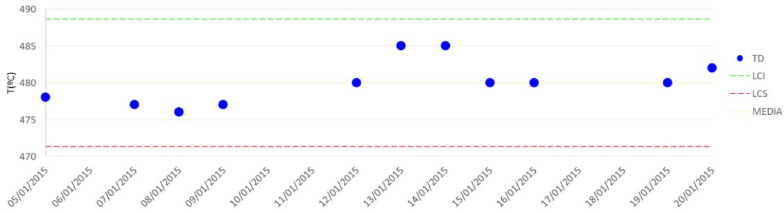
**Figura 41.** Muestreo y representación de los límites de control para la zona derecha de la caldera
