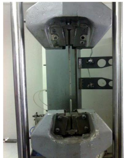
**Figura 28.** Muestra en la máquina de tracción de TQ después de la rotura
