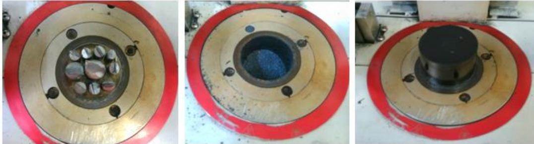
**Figura 31.** Metodología para bakelitas: antes de la transformación, tras el llenado y después de la transformación de la bakelita en el horno
