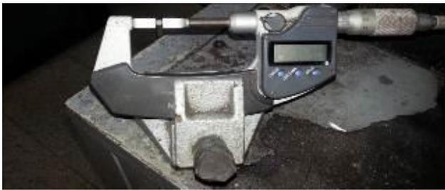
Figura 29. Medición del cuello de estricción
