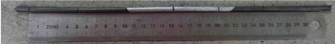
**Figura 27.** Muestra enderezada con las marcas de la longitud inicial
