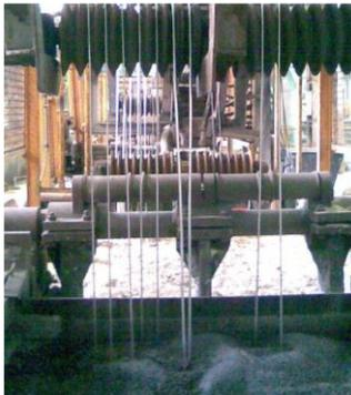
**Figura 10.** Salida del baño de Zn
