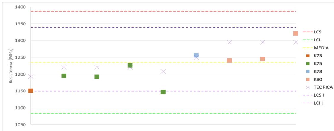
**Figura 44.** Resistencias a tracción de K73- K80 y representación de los límites de control reales y teóricos.
