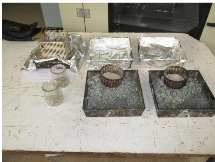
Ilustración 22. Cesta de escurrimiento y material de ensayo.
