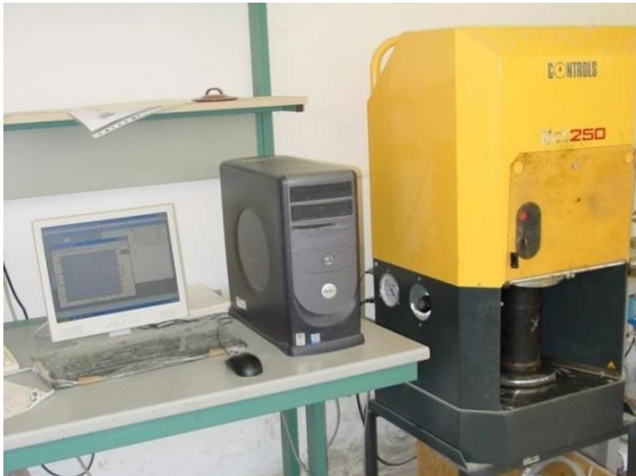
Ilustración 26. Compactadora giratoria (GCS/GITECO).
