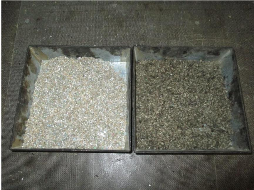
**Ilustración 11.** Fibra de celulosa sin granular y granulada con betún.
