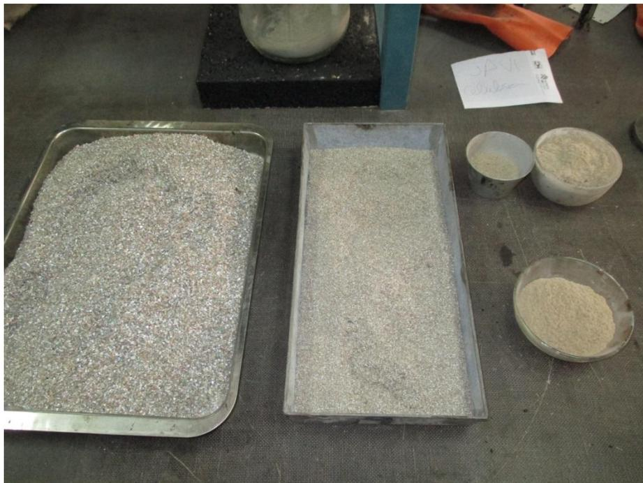
**Ilustración 20.** Muestra del triturado de brik tamizado por tamaños: 2-1 mm; 1-0,5 mm; 0,5-0,25 mm; <0,25mm.
