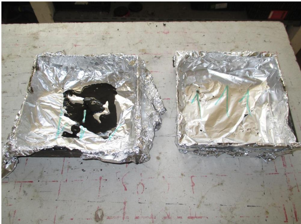
**Ilustración 35.** Escurrimientos de probetas con un contenido de 5% de betún sobre mezcla: sin fibra (izda.) y con un 0,25% de fibra de brik (dcha.).
