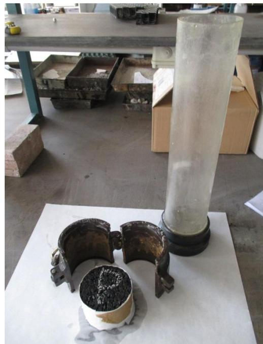
**Ilustración 23.** Permeámetro de carga variable (GITECO, GCS).
