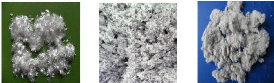
Ilustración 13. Fibras de poliéster, celulosa y lignina [35].
