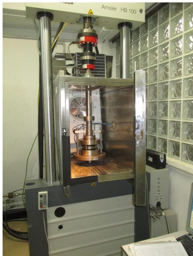
**Ilustración 25.** Dispositivo para ensayo de compresión triaxial cíclica (GITECO).
