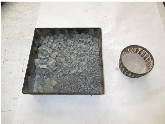
**Ilustración 18.** Muestra de árido ofítico y filler de aportación calizo.
