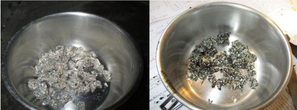
**Ilustración 21.** Fibras de brik aglomeradas con betún antes y después de calentar en estufa.
