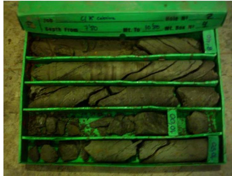
**Fotografías 11 y 12:** cajas portatestigos 3 y 4 del sondeo S-2, de 4.80 a 7.80 m. y de 7.80 a 10.80 m de profundidad respectivamente
