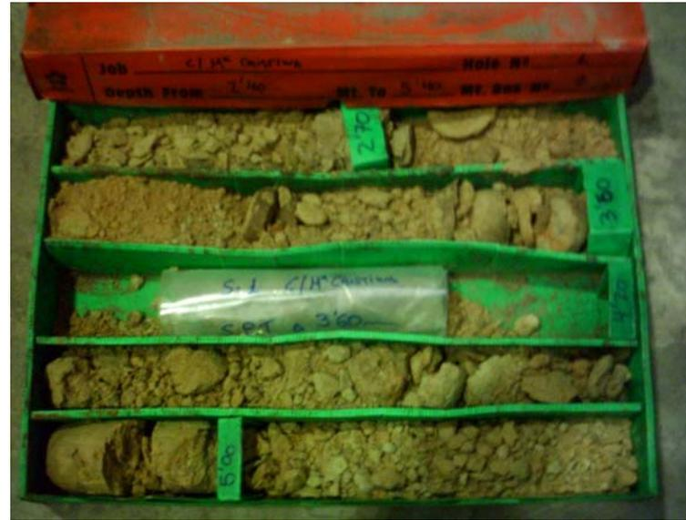
**Fotografías 3 y 4:** cajas portatestigos 1 y 2 del sondeo S-1, de 0,00 a 2,40 m y 2,40 a 5.40 m de profundidad respectivamente
