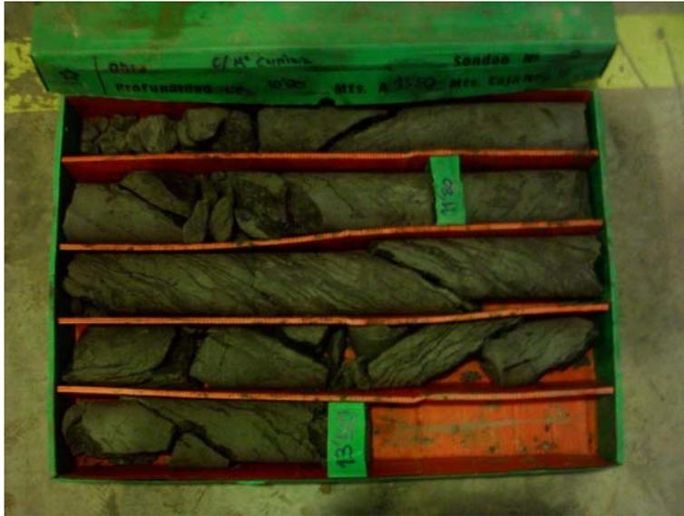
**Fotografía 13:** caja portatestigos 5 del sondeo S-2, de 10.80 a 13.50 m de profundidad
