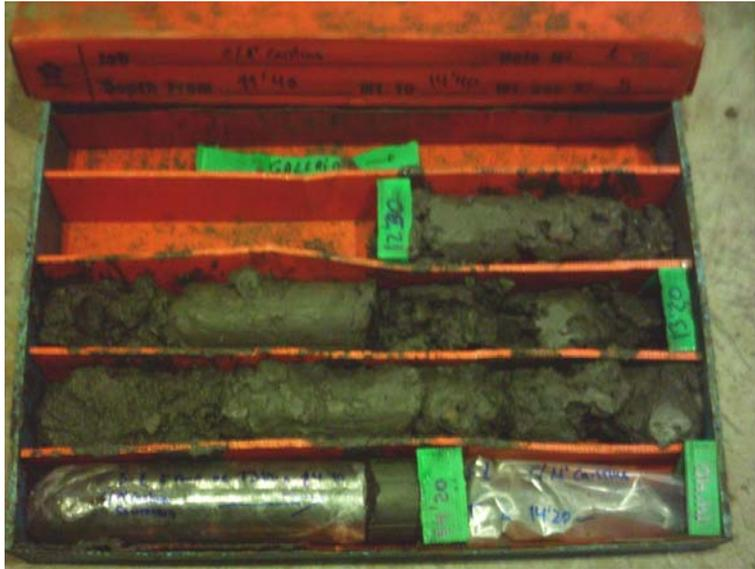
**Fotografía 7:** caja portatestigos 5 del sondeo S-1, de 11.40 a 14.40 m de profundidad
