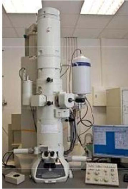
**Figura 18:** Imagen del microscopio electrónico empleado (JEOL modelo JEM-2100)
