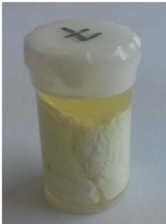
**Figura A2.1:** Crema solar degradada tras ser sometida a RX. Se puede apreciar claramente la separación de componentes de la formulación.
