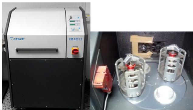
Figura 5. Molino Retsch PM400/2, a la izquierda por fuera y cerrado, como cuando se encuentra en funcionamiento. A la derecha el interior incluyendo las dos vasijas ya fijadas.
