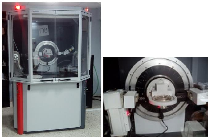
Figura 9. Bruker D8 Advance, difractómetro empleado. A la izquierda se puede ver el aparato completo, mientras que a la derecha se observa en detalle la muestra, el goniómetro, el tubo de rayos X y el detector.
