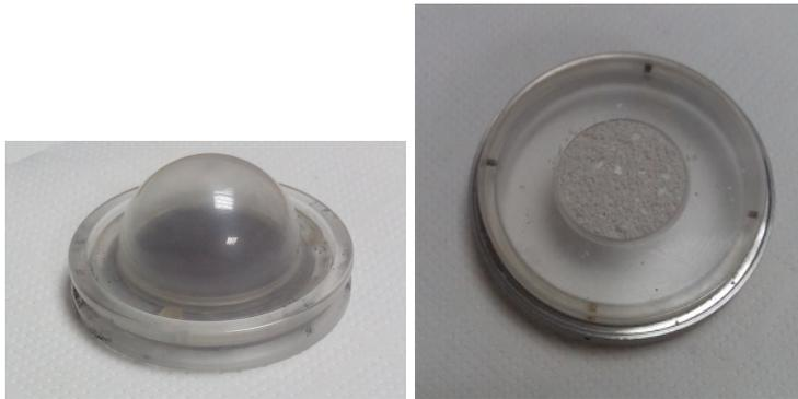
Figura 8. A la izquierda, portamuestras con cápsula empleado para las medidas de hierro, con el cual se opera en la cámara de guantes a fin de evitar la oxidación de la muestra debida a la atmósfera. A la derecha, el portamuestras empleado para las medidas del caucho.
