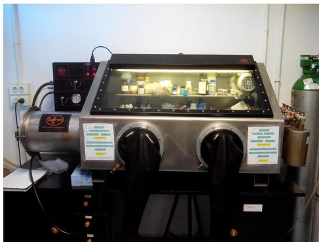
Figura 6. Cámara de guantes con atmósfera de argón. Se puede observar la bombona con el gas argón, el puerto de entrada y los guantes.
