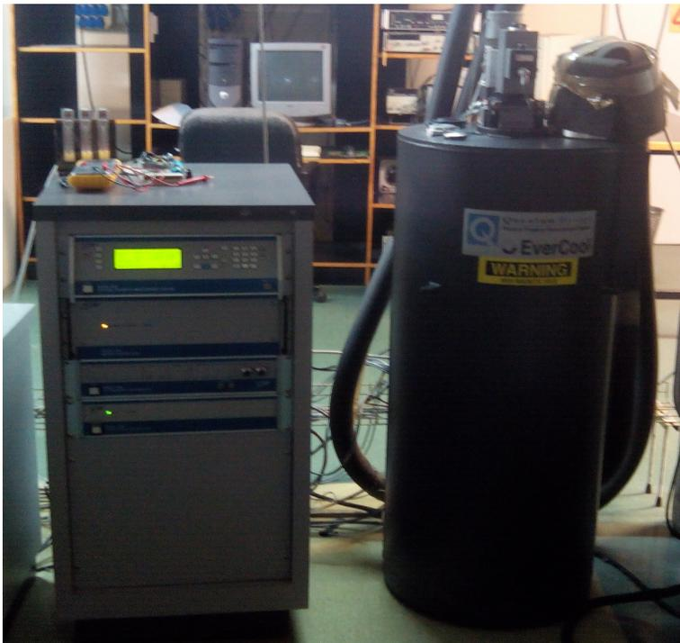
Figura 10. Quantum Physical Property Measurement System. Se puede observar el dewar (a la derecha), y el servomotor encima de él.
