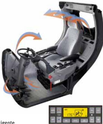
El aire acondicionado electrónico de alto rendimiento proporciona un flujo de aire que se ajusta perfectamente a las condiciones ambientales. Sus cinco modos de funcionamiento satisfacen incluso al operador más exigente.
