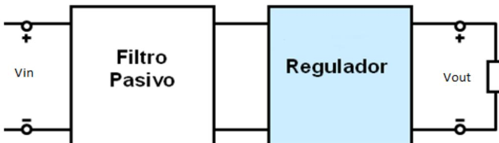
*Figura 7. Esquema de la fuente de alimentación*
