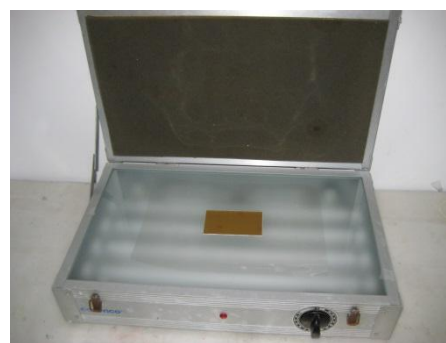
Figura 4.21 Proceso de velado de la PCB.
