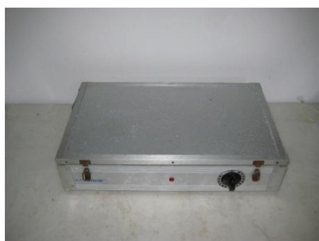
Figura 4.21 Proceso de velado de la PCB.
