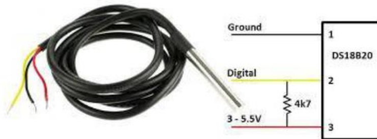
Figura 2.20 Conexión del sensor DS18B20.
