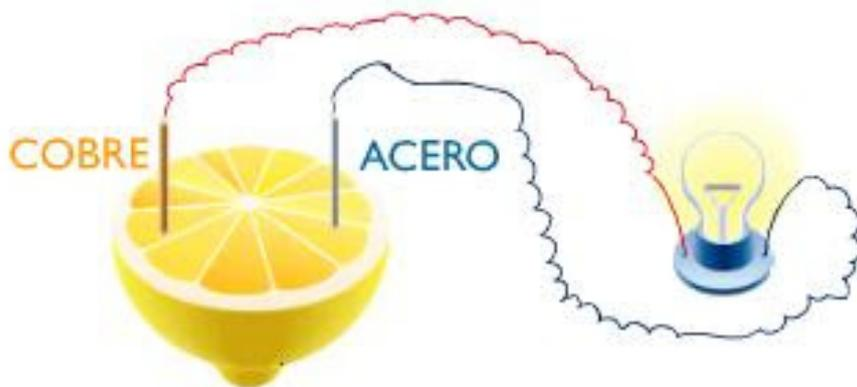
Figura 17: En la imagen observamos que se utilizan como metales el cobre y el acero.
