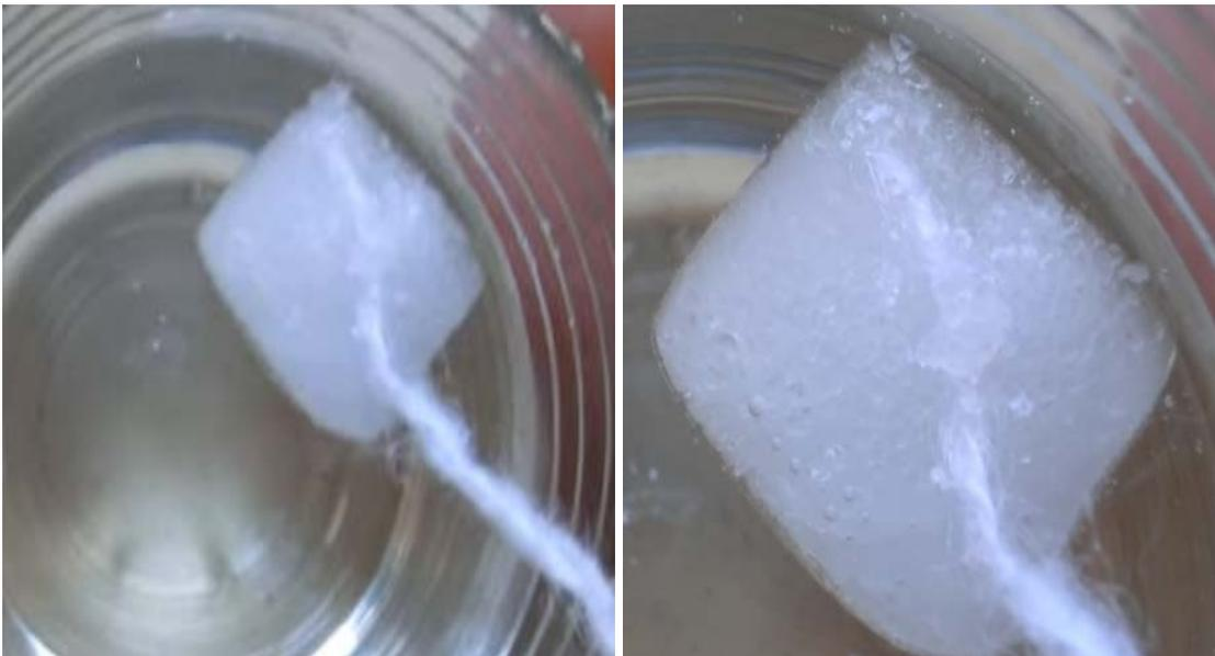
*Figura 7: Aquí se observa como la sal disuelve la parte posterior del hielo y, pasado un tiempo, se vuelve a congelar por el mismo frío del hielo, con el cordel en su interior.*
