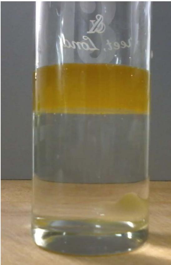
*Figura 3: Mezcla de aceite y agua donde se observa que el aceite tiene menos densidad que el agua, por tanto flota sobre ella.*
