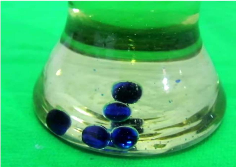
*Figura 2: Gotas de agua líquida con tinta que se agrupan en el fondo del vaso, al pasar por la interfase de aceite.*
