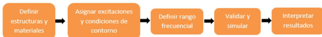
Figura 2.10. Proceso de simulación con HFSS
