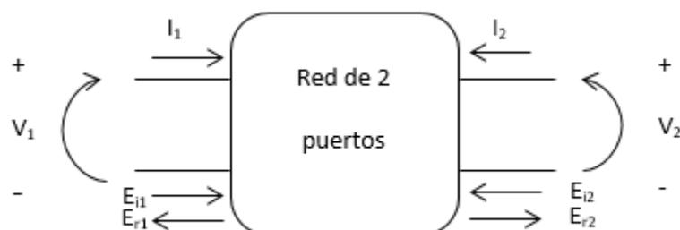
Figura 2.1 Red de 2 puertos. Tensiones, corrientes y ondas incidentes y reflejadas.
