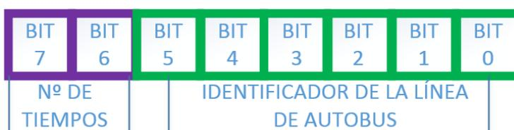
Figura 5.7 Estructura de información de línea de bus
