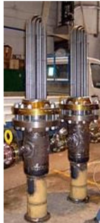
Son de tipo carcasa y tubos y como indica su nombre este tipo de intercambiador de calor consta de un gran recipiente a presión (carcasa) con un haz de tubos en su interior. El gas natural pasa a través de los tubos y el agua caliente por fuera de los tubos (a través de la carcasa) para transmitir el calor entre los dos fluidos.
