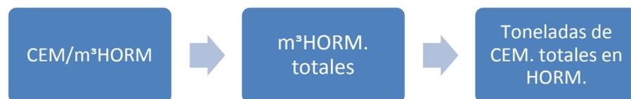
**Figura 15: Esquema del proceso de obtención de las toneladas de cemento utilizadas en la fabricación de los distintos hormigones empleados en la obra.**
