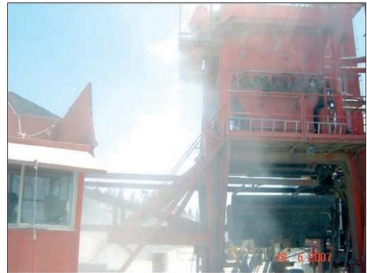
Fig. 13 Fabricación de mezcla semicaliente por espumación inducida.
