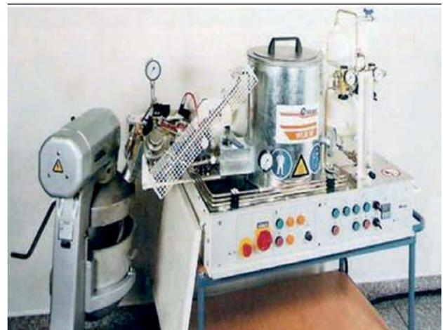
Fig. 15 Planta de laboratorio de espuma de betún.
