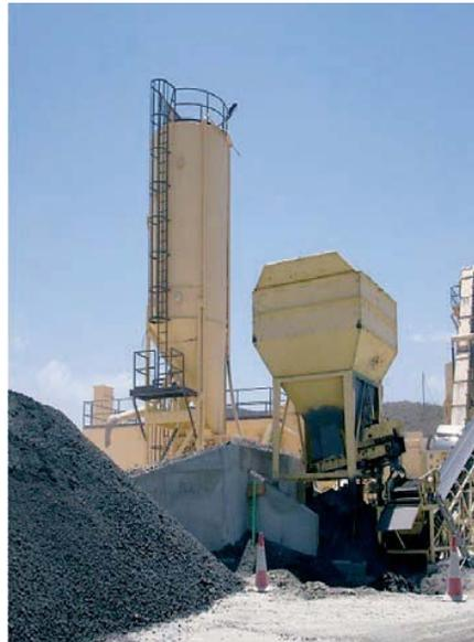
Fig. 5 Planta para reciclado en caliente de alta tasa y acopio de RAP.
