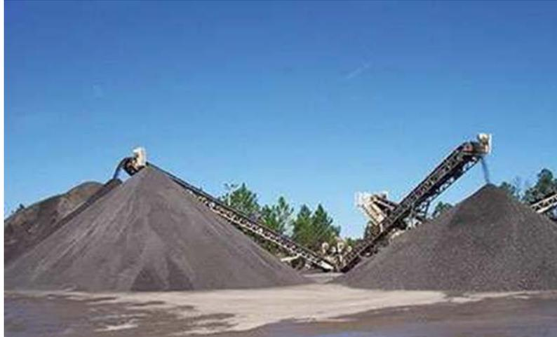
Fig. 19 Acopio de RAP fraccionado.
