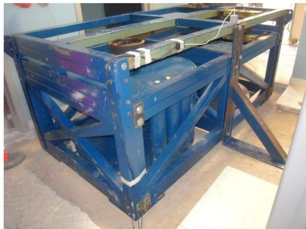
Figura 3.6.3. Vibrodyne electromecánico.
