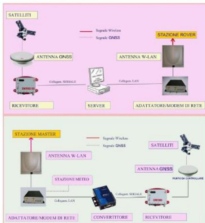
Figura 2.4.6.3.4. La transmisión de datos de la Master (arriba) y de la Rover (abajo).
