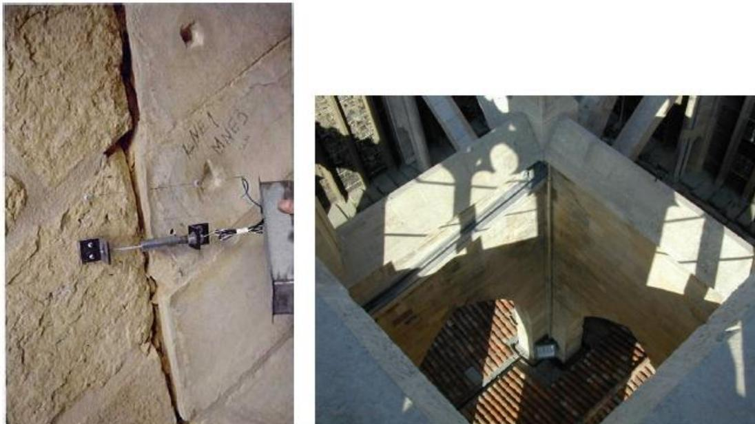
Figura 3.2.10. En la parte izquierda, disposición del transductor inductivo ubicado en la grieta norte, habida cuenta del taladro realizado para el termopar empotrado. A la derecha, vista del inclinómetro colocado en el ángulo
