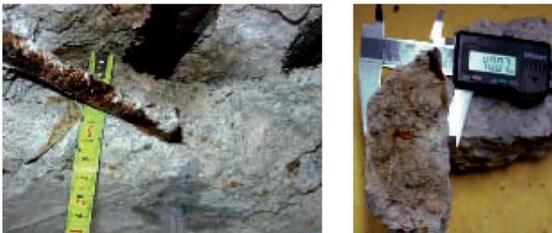
Figura 3.3.3. Medida del frente de carbonatación.
