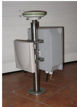
Figura 2.4.6.3.3. Unidad Rover, con la antena GNSS y la antena WLAN.
