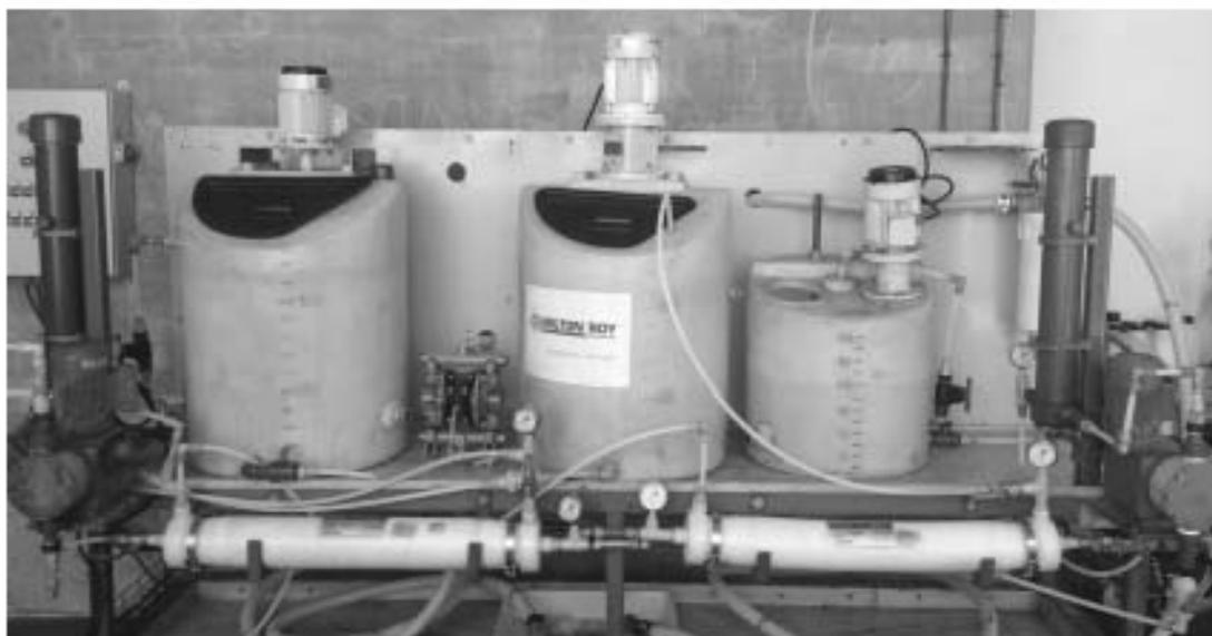
**Figura 2.3.** Planta piloto de extracción líquido-líquido no dispersiva.
