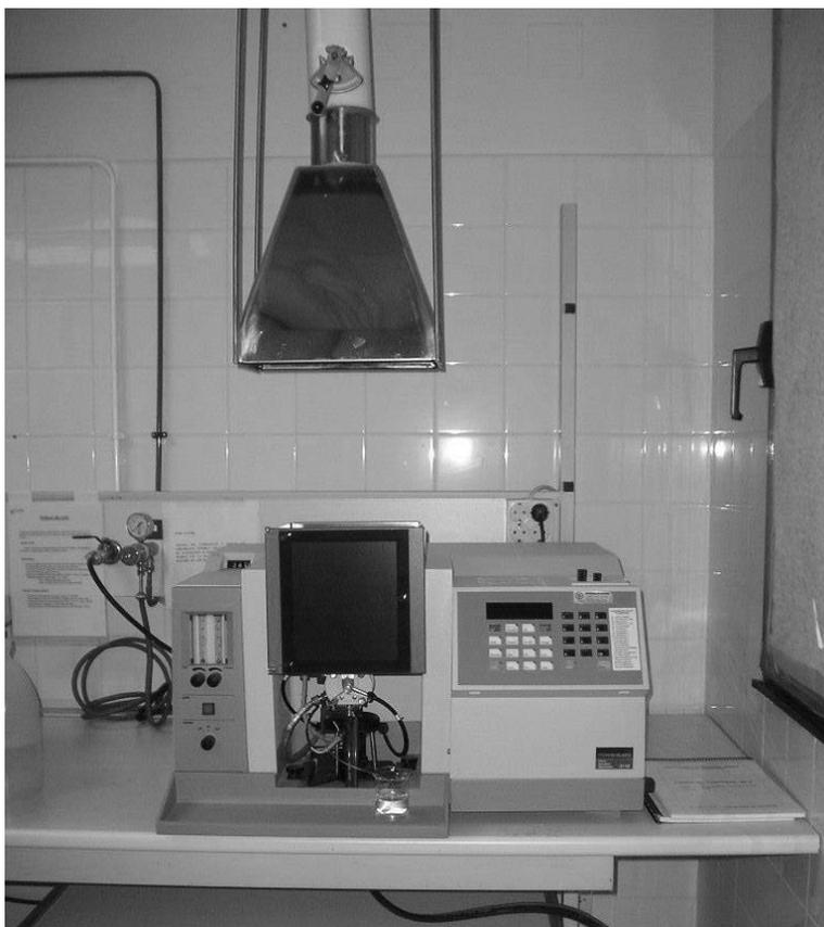
**Figura 2.5.** Espectrofotómetro de absorción atómica PERKIN ELMER 3110B.
