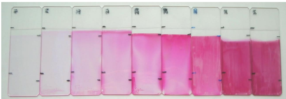
Figura 3.3. Películas de Sap con distintas cargas de colorante PY, de izquierda a derecha: 0.9%CEC, 1.7%CEC, 3.7%CEC, 6.6%CEC, 10%CEC, 20%CEC, 22%CEC, 31%CEC y 32%CEC.
