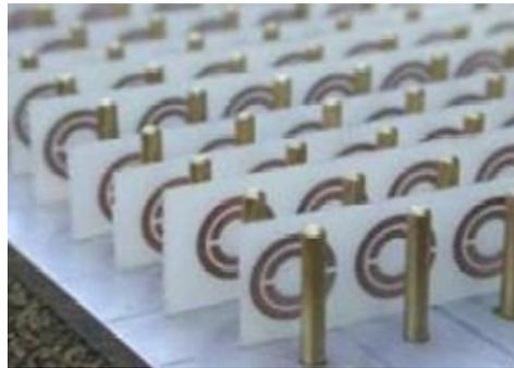
Figura 1: Imagen correspondiente al metamaterial propuesto por Pendry y fabricado por Smith [13].
