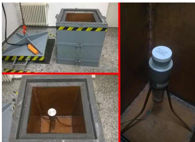
Figura 11. Se muestra el detector centelleador de NaI(Tl) dentro del blindaje de plomo, así como una de las muestras colocada en disposición para medir.
