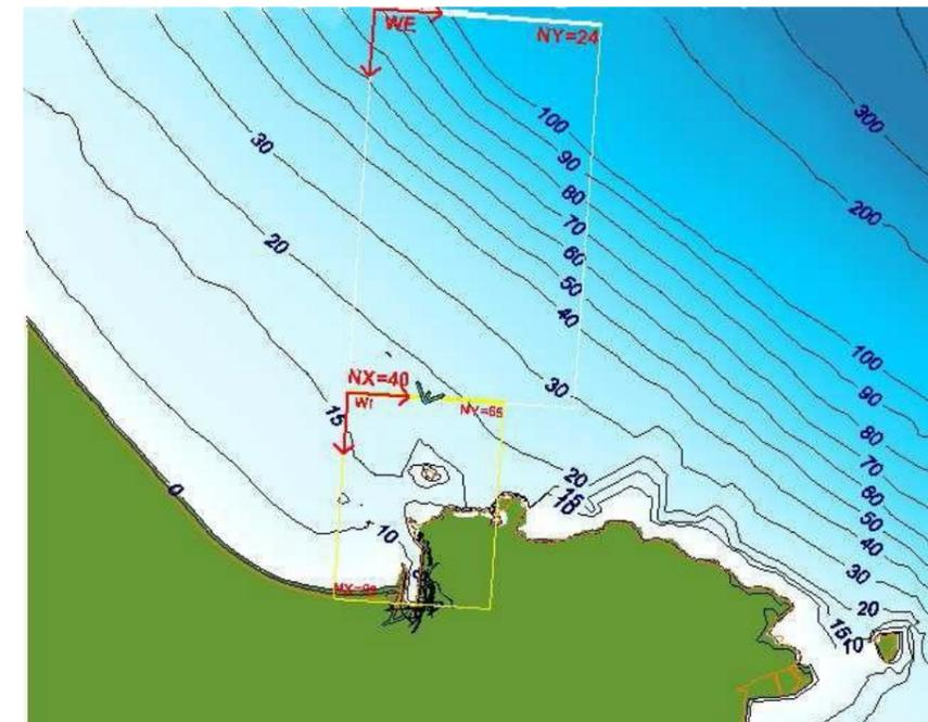
Figura 5.5 Malla orientada al Norte utilizada para la propagación del oleaje
